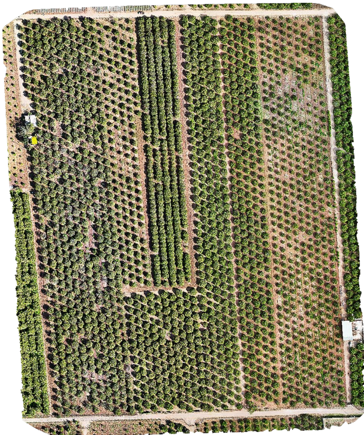
Figura 13: Ortomosaico generado en ODM con imágenes capturadas a 30 metros con VANT Fuente: Elaboración propia.
