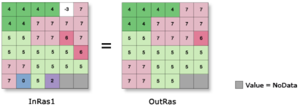
Fig. 2.12 Ráster de entrada y de salida después de utilizar el filtro mayoritario para reducir el ruido de la imagen (ESRI, 2016).
