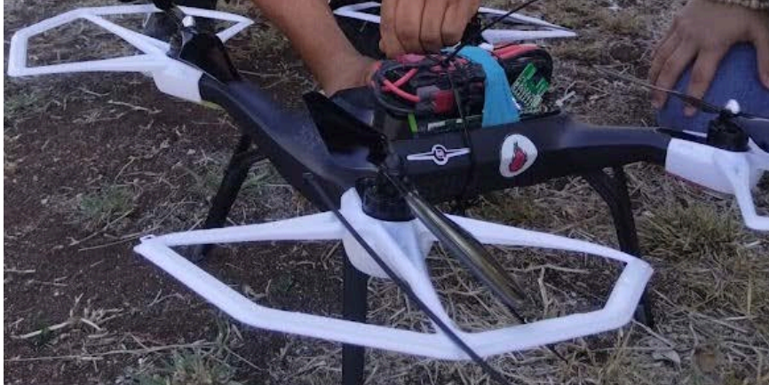
Figura 5.20. VANT marca 3DR modelo SOLO con el que se realizaron experimentos. Imagen propia.
