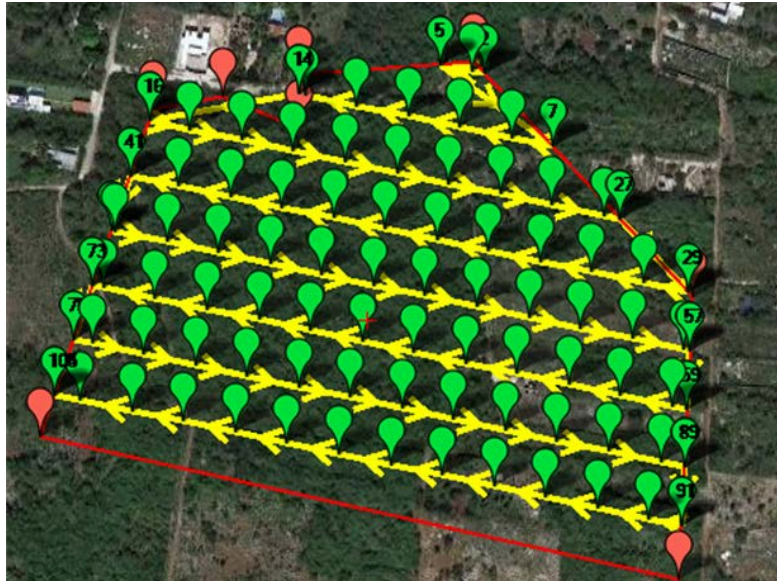
Figura 5.21. Ejemplo de un plan de vuelo para el VANT SOLO generado con el software libre ArduPilot. Imagen propia.
