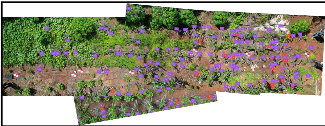
Figura 5.16. Ortomosaico con 4 imágenes obtenidas a cada 5 m longitudinales sobre la parcela a 6 m de altura, con 50% de corte de confianza.
